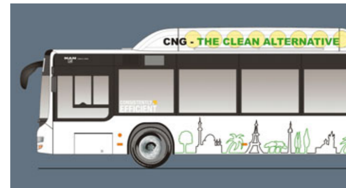
CNG-Speichersystem mit bis zu 1712 Liter Volumen.
