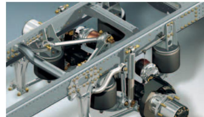
Luftfederung an der Hinterachse des 13-Tonnners.
