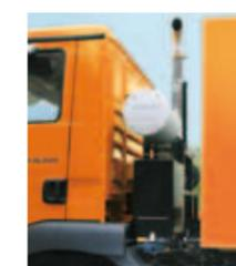
Ideale Vorbereitung für den Kehrmaschinenaufbau: Seitliche Anbauteile wie Batteriekasten, Luftansaugung und Auspuffanlage sind hinter dem Fahrerhaus angeordnet. Tank optional hinter der Hinterachse.
