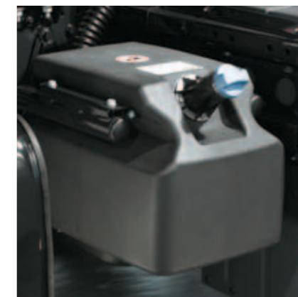
Separater AdBlue®-Tank für Baufahrzeuge.
