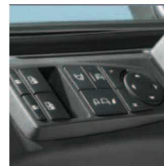
Ergonomisch gestaltetes Türbedienmodul für Türverriegelung, Spiegelverstellung und Fensterheber.
