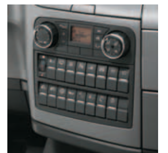
Bedienelemente für Klimaanlage, Heizung und Lüftung. Schalterfeld mit Funktionsanzeigen.
