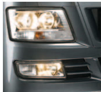
Scheinwerfer mit Freiformreflektoren, Xenon-Abblendlicht.
