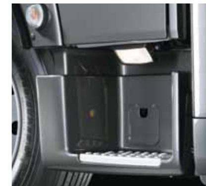
Rangierleuchte im Beifahrereinstieg erhellt den Sichtbereich des Rampenspiegels.
