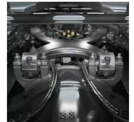
Gewicht sparender X-Lenker an der Hinterachse übernimmt Stabilisator- und Lenkerfunktionen.
