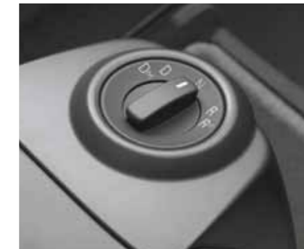
Drehschalter MAN TipMatic®.
