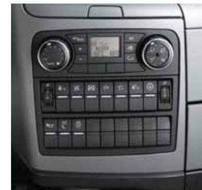
Bedienelemente für Klimaanlage, Heizung und Lüftung. Schalterfeld mit Funktionsanzeigen.
