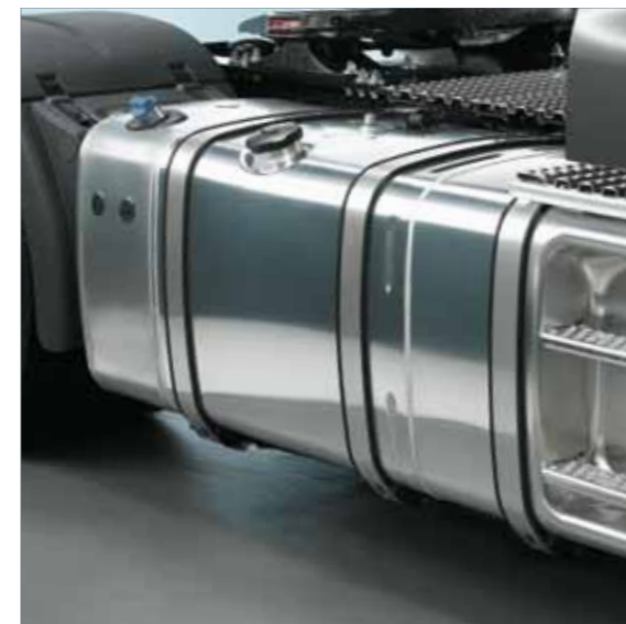
Kombitank für Diesel und AdBlue®.
