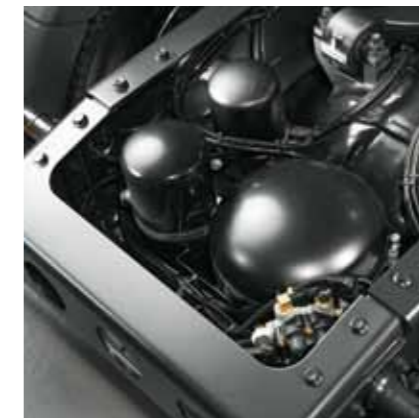
Druckluftkessel im Heck angeordnet.
